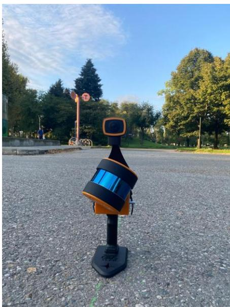
Figura 28: Posizionamento a terra e avvio della scansione tramite laser scanner.
