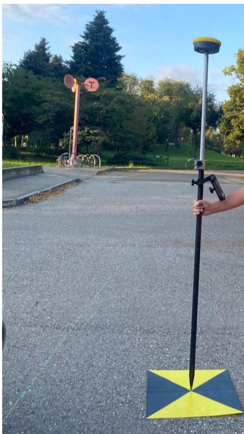
*Figura 27: Posizionamento dei target e acquisizione coordinate tramite antenna GNSS nel Parco Ruffini (foto dell'autrice).*
